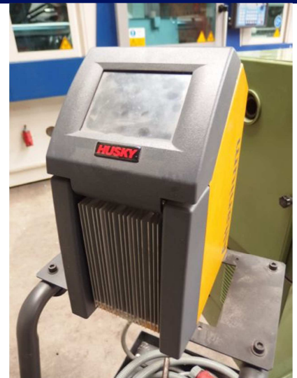
Atemperador canal caliente 6 zonas electrónico HUSKY Altanium X-C-6 NEO2-6 Ref: 17698
